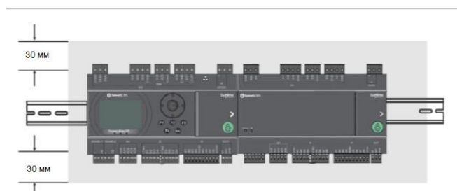
Рисунок 1 Горизонтальная установка устройств SystemePLC SR на DIN-рейку
